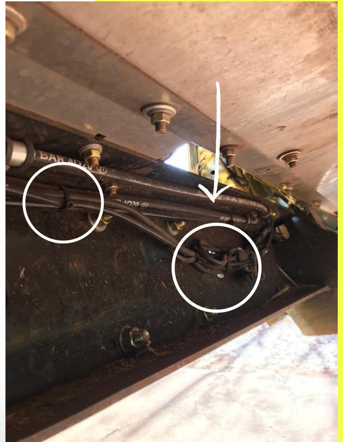
**FIXE O SUPORTE DO CABO MÁQUINA, APÓS ISSO, VERIFICAR TODA A INSTALAÇÃO ESTANDO TUDO NAS CONFORMIDADES O EQUIPAMENTO JÁ PODE SER CALIBRADO E PRONTO PARA O USO.**
