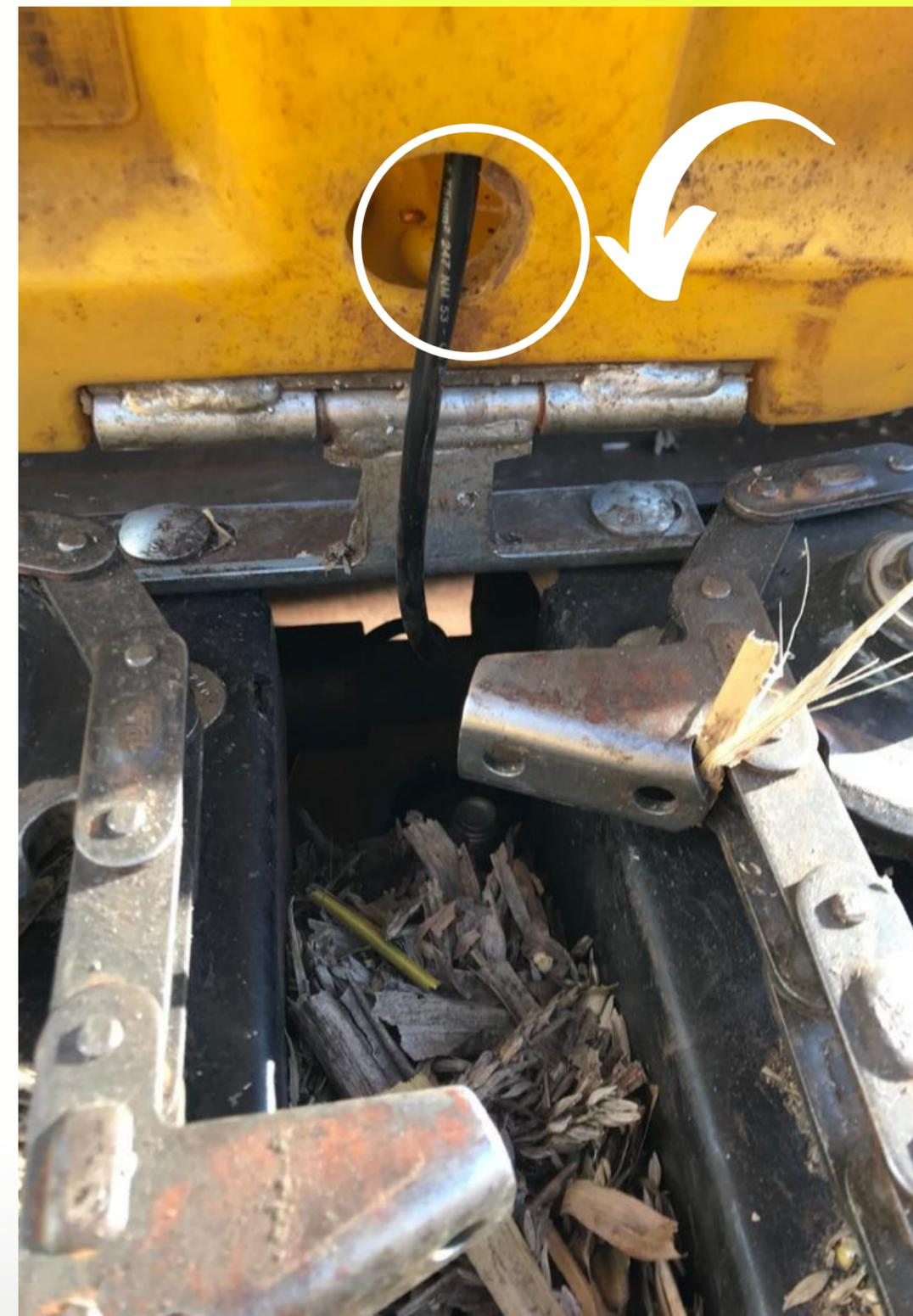
**1º) SOLTE APROXIMADAMENTE 3 VOLTAS COMPLETAS DA PORCA DOS PARAFUSOS DEMARCADOS, UTILIZANDO UMA CHAVE CATRACA COM ALONGADOR E PITO N°17**
