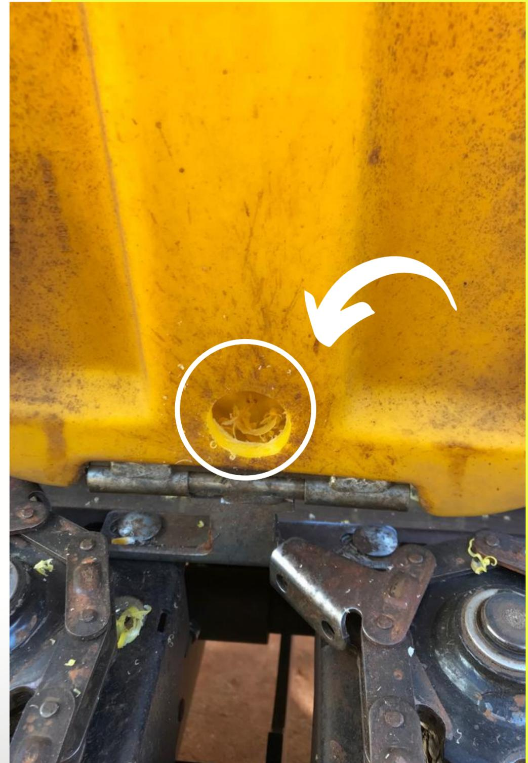
**FINALIZANDO A FURAÇÃO DOS BICOS/CAPÔ, PASSE A EXTENSÃO DO SENSOR, ATRAVÉS DOS FUROS. CADA EXTENSÃO POSSUI UMA DEMARCAÇÃO. ESQUERDO, CENTRAL ESQUERDO, CENTRAL, CENTRAL DIREITO, DIREITO, DE ACORDO COM O TAMANHO DO KIT 4, OU KIT 3 SENSORES.**
