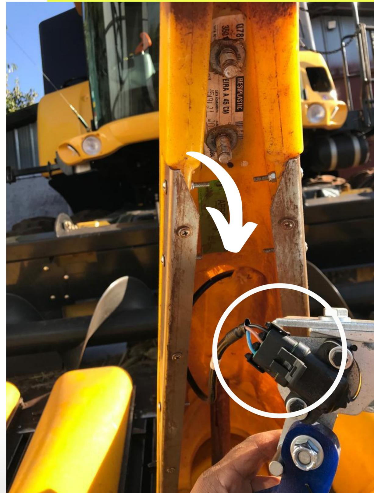
**APÓS CONECTAR A EXTENSÃO ENCAIXE O DISPOSITIVO SENSOR DENTRO DO BICO, E RECOLOQUE AS PORCAS COM UM AUXILIO DE UMA CHAVE L OU CATRACA N° 17 E APERTE AS PORCAS DESTA FORMA FIXANDO O DISPOSITIVO SENSOR E A PONTEIRA DO BICO.**
